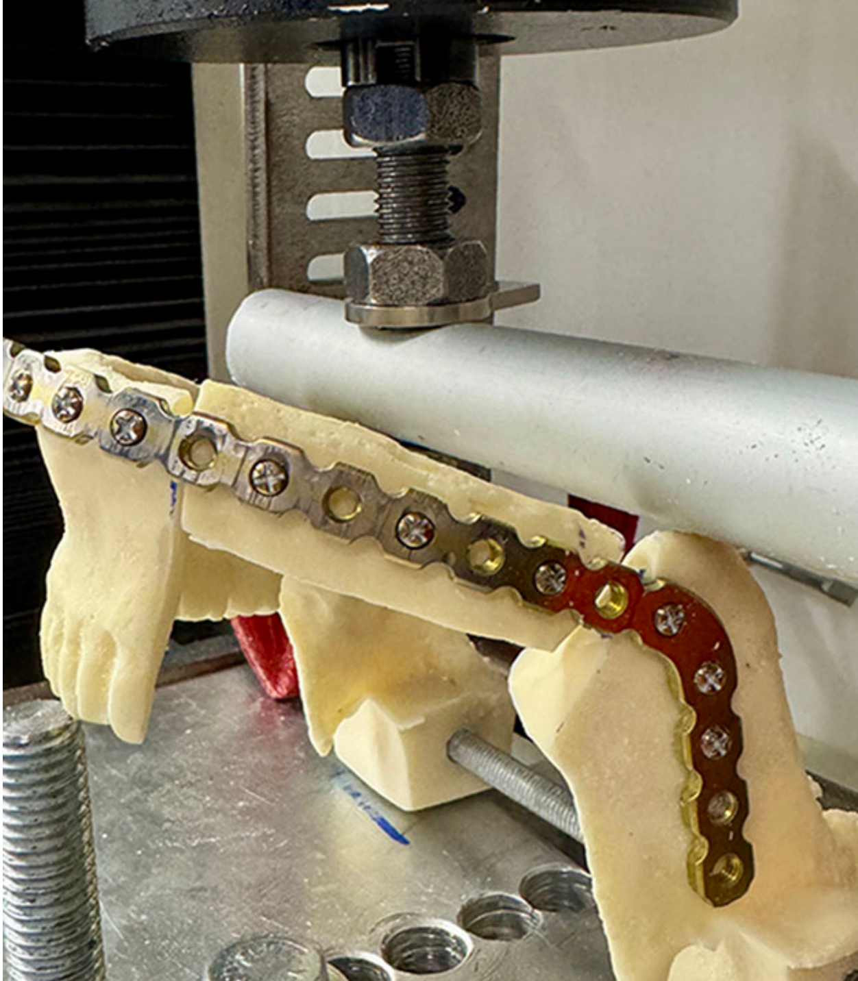
Yüksek profil kalınlıklı plak ve fibula benzeri greft ile rekonstrükte edilmiş mandibula modelinin biyomekanik test için hazırlanmış görünümü Mandibular reconstruction model with a high-profile plate and fibula-simulating graft positioned for biomechanical testing
